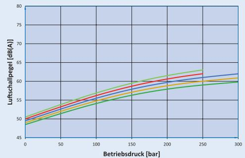
Messbedingungen: Drehzahl 1450 min<sup>-1</sup>, Viskosität 46 mm<sup>2</sup>/s, Betriebstemperatur 40°C
