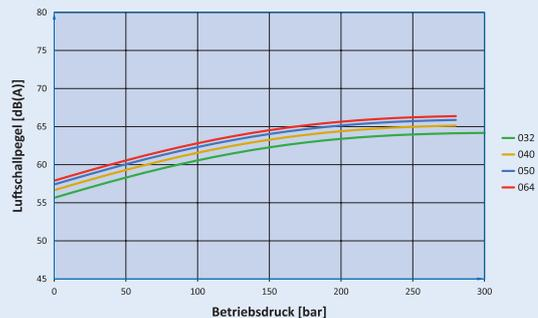
Messbedingungen: Drehzahl 1450 min<sup>-1</sup>, Viskosität 46 mm<sup>2</sup>/s, Betriebstemperatur 40°C
