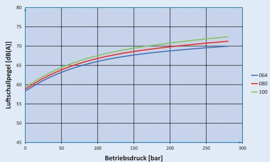
Messbedingungen: Drehzahl 1450 min<sup>-1</sup>, Viskosität 46 mm<sup>2</sup>/s, Betriebstemperatur 40°C
